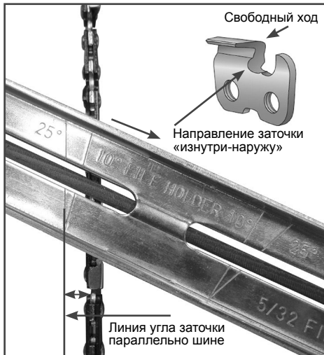
Рис. 22 Расположение линии угла заточки
