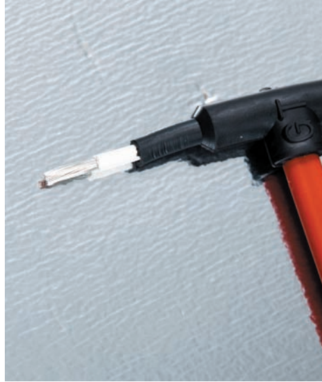
Рис. 6. Вид провода со снятыми слоями изоляции
