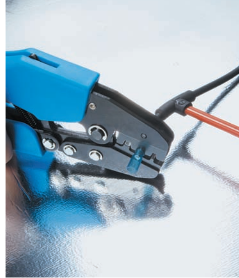
Рис. 7. Зажатие гильзы в термоусаживаемой трубке
