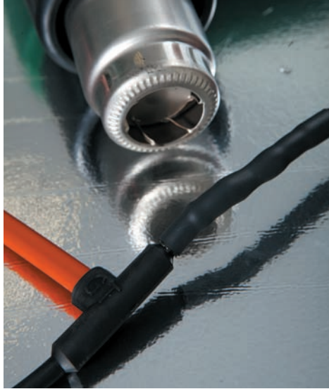
Рис. 14. Усадка термоусаживаемой трубки техническим феном
