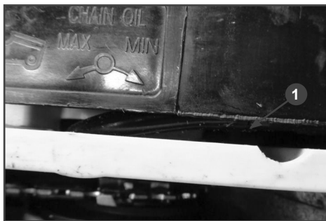
Рис. 8 Винт регулировки подачи масла
