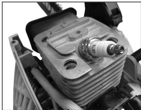
Рис. 28 Охлаждающие ребра цилиндра
